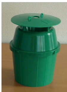
Figure 31. Les pièges à entonnoir sont adaptés pour le suivi des vols de processionnaire du chêne (Maxime Guérin, Plante & Cité)
